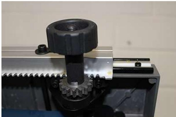
Großes Plus der CWT 255 Baukreissäge von Norton Clipper ist die besonders hochwertige und leichtgängige Doppelführungsschiene: Mit Hilfe der zwei an vorderer und hinterer Seite des Schneidtisches installierten Profilleisten lässt sich die Säge äußerst präzise und sicher einstellen. So erfolgen saubere Schnitte zügig und ohne großen Aufwand.
