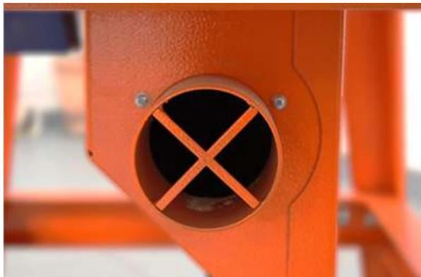
Zum Schutz von Anwender, Raumluft und Umgebung können die Baukreissägen CWT 315 und CWT 450 sowohl an professionelle Absauganlagen als auch an einfachere Werkstattdsauger angeschlossen werden.
