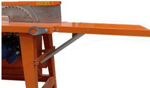
Der 885 x 700 mm (CWT 315) beziehungsweise 1.000 x 780 mm (CWT 450) große Schneid­tisch der Baukreissägen verfügt über einen zusätzlichen ausklappbaren Tisch (Gesamtlänge in der maximalen Ausführung 1.890 mm). Damit lassen sich auch längere Werkstoffe sicher ablegen und führen.
