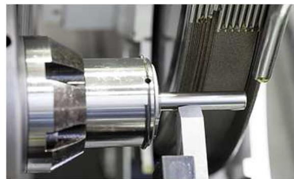
***Die neuen galvanischen Norton Winter-AEON-Hochpräzisionsschleifscheiben beim Einsatz auf der GRINDSTAR von Junker. Die konstruktiven Vorteile dieses „Performance-Doppels“ reizen das Hochleistungs-Einsteichschleifen effizient aus.***
