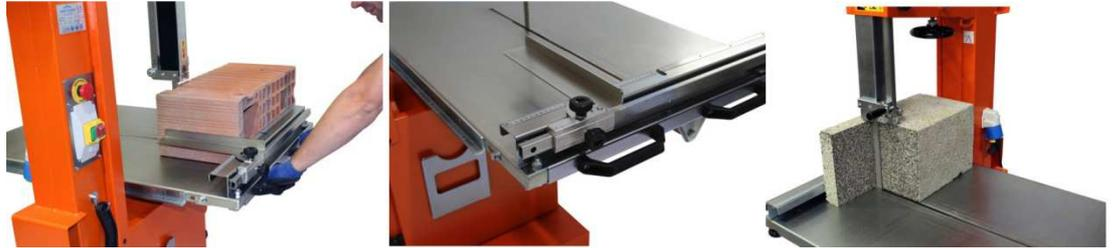
**Die neuen Bandsägen entsprechen den EHS-Sicherheitsanforderungen und liefern dank konstruktiver Vorteile wie etwa Winkelschnittführung (mitte) präzise Schnittergebnisse ab (rechts).**
