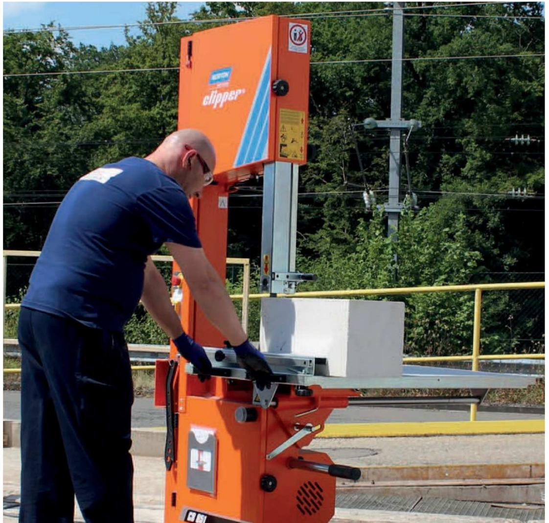
**Die Bandsäge CB651 (Schnitttiefe 635 mm) ermöglicht schnelle und saubere Schnitte durch Leichtbausteine bis zu einer Materialhöhe von 646 mm.**
