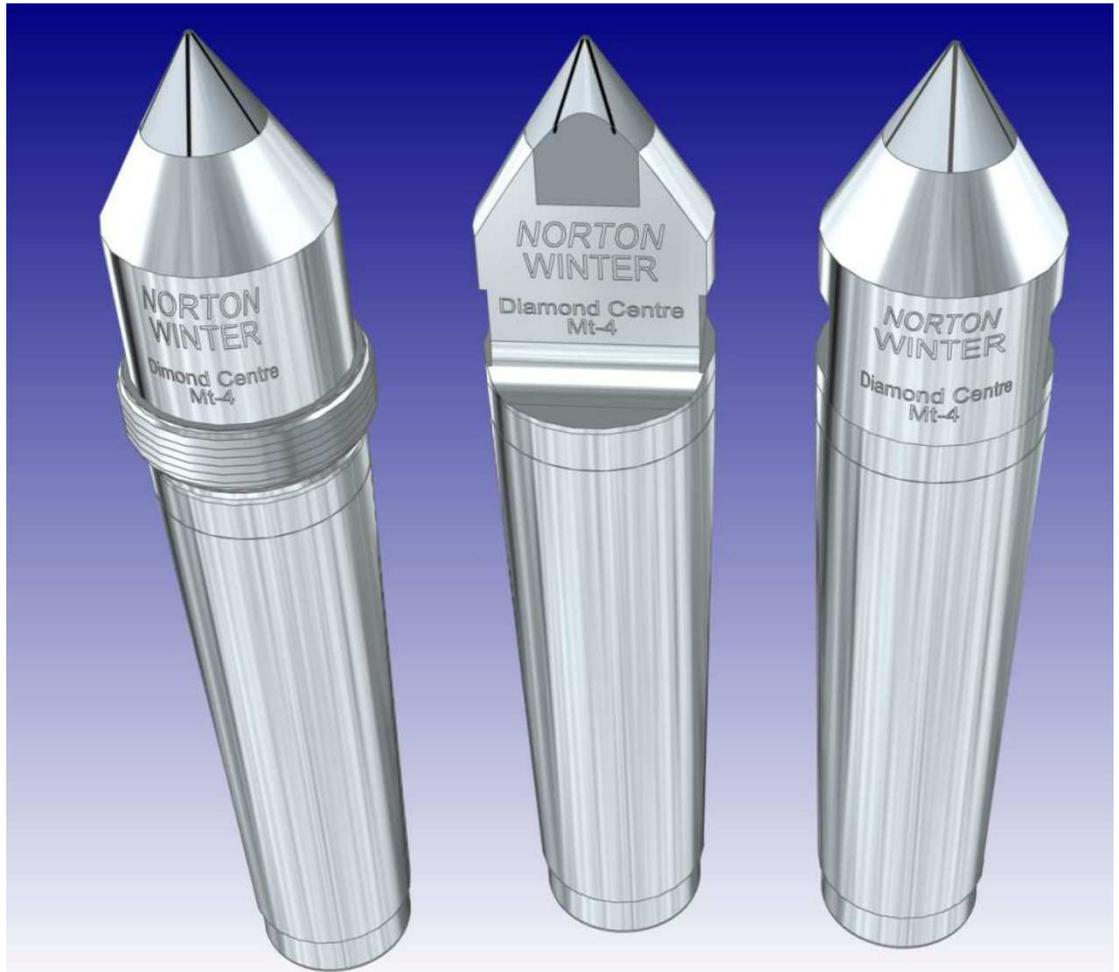
***Norton Winter-Zentrierspitzen sind im Eingriffsbereich aus Hartmetall gefertigt, die mit PKD verstärkt sind. Die Spannwerkzeuge gibt es in Standard-Abmessungen als Lagerware in drei Typen (Vollspitze DIN 806; Halbspitze DIN 806H und mit Gewinde DIN 807) in fünf Größen.***
