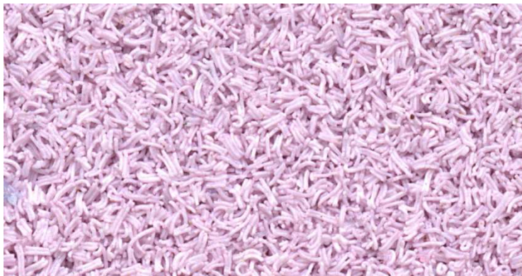
Norton Altos-Schleifscheiben sind mit dem patentierten Stäbchen-Sinterkorund ausgerüstet.
